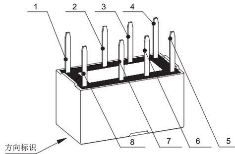
备注: (1) 产品部分外形尺寸未注尺寸公差, 当外形尺寸 $\leq 1\text{mm}$ , 公差为 $\pm 0.2\text{mm}$ ; 当外形尺寸在 $(1 \sim 5)\text{mm}$ 之间时, 公差为 $\pm 0.3\text{mm}$ ; 当外形尺寸 $> 5\text{mm}$ , 公差为 $\pm 0.4\text{mm}$ ;
