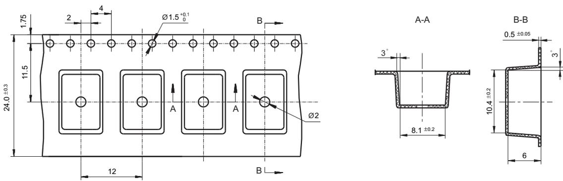
载带外形图 (S1型: 短脚表面贴装型)
